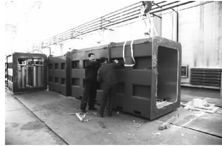
图为北重集团工程机械公司员工正在对KJYF-96/10型矿用可移式井下救生舱进行装配。
