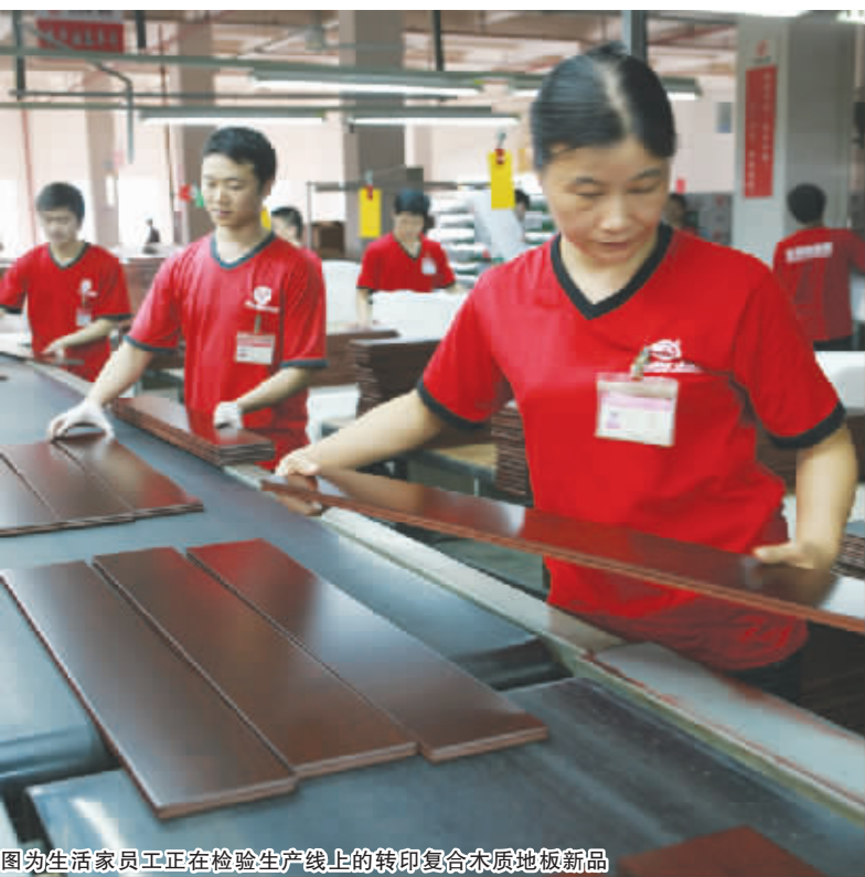
图为生活家员工正在检验生产线上的转印复合木质地板新品
