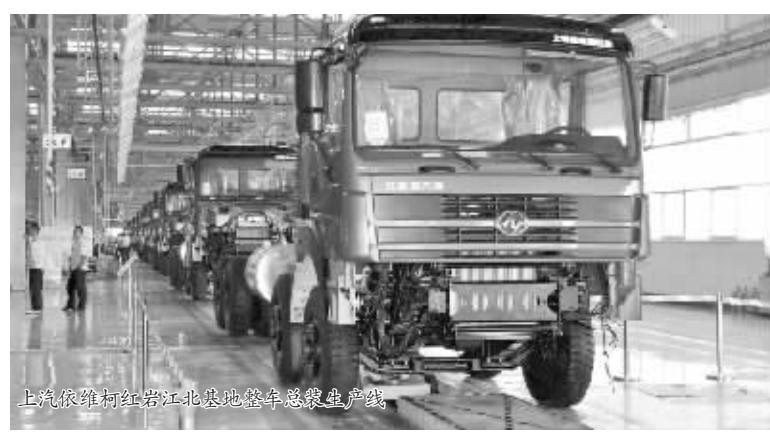
上汽依维柯红岩江北基地整车总装生产线
