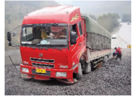
6月25日上午“万里行”采访团赴210国道大山塘避险车道现场参观采访。 位于南丹县境内的210国道大山塘处于云贵高原边缘,坡道全长4.5公里,载重汽车下坡经常出现刹车失灵。2006年底,河池市投资85万元建成紧急避险车道,已成功解救158辆大货车和465人生命。图为2008年3月15日15时许,班华林驾驶赣CD0917货车因刹车失灵,驶进G210线2719公里加700米处右侧避险车道,车辆轻微损坏,车上2人无伤亡。
