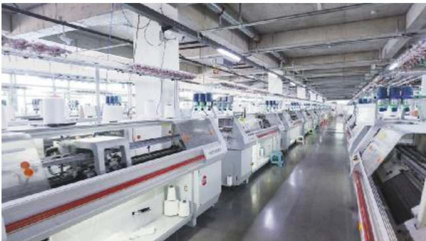
■ 邢台市清河县国际羊绒高端针织产业园一线成型电脑横机正在生产羊绒制品。
