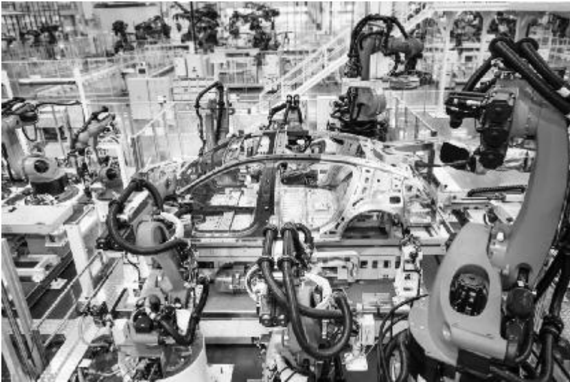
●这是位于合肥市肥西县的江淮汽车尊界超级工厂内的自动化焊接生产线，该工厂是江淮汽车携手华为专门为尊界品牌打造的工厂。新华社发
