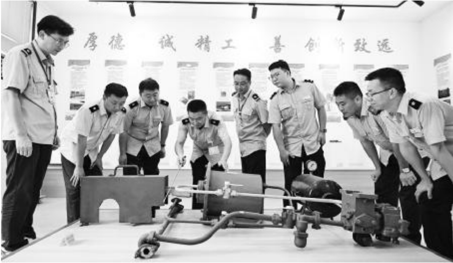
●“丁丁工匠工作室”成员在研究K车风动自卸装置原理。
