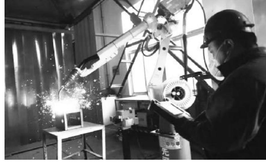
自动化技术，先后引进智能焊接机器人、智能等离子切割机等设备，为现场作业植入“智能因子”。通过采取自动化、数字化、智能化作业模式取代传统人工作业模式，达到了减人提质、节本降耗的目的。
