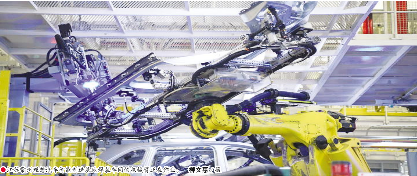
江苏常州理想汽车智能制造基地焊装车间的机械臂正在作业。 柳文惠/摄
