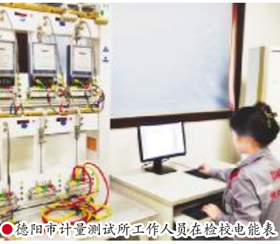
德阳市计量测试所工作人员在检定电表
