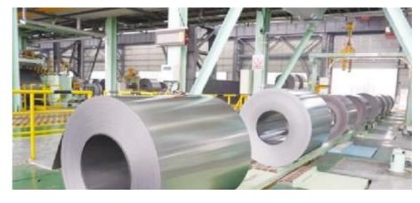
脂、连铸退火、涂层、干燥等9个步骤操作,32分后,冒着热气的硅钢从出料口缓缓下线,分卷机"接过"产品打捆、称重。一卷长5100米、重23吨的钢材"摇身一变"为高端精品硅钢。
