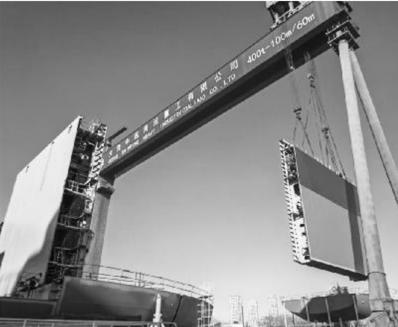
●大连中远海运重工有限公司的龙门吊正在吊装船舶构件。
