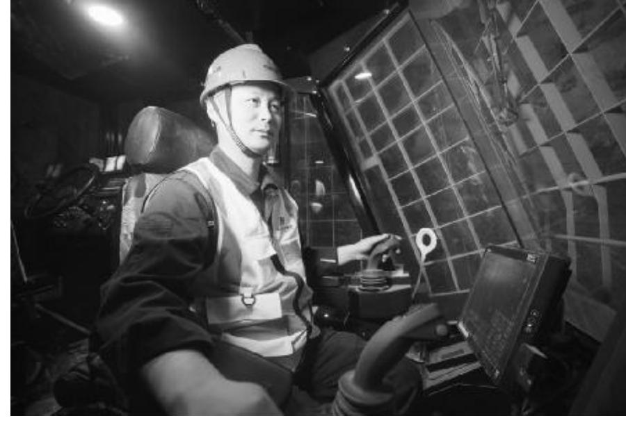
分钟3-5米，钻一个5米深度的孔仅需1.5分钟，采用封闭式驾驶室，避免了粉尘和噪音对人体的损害，且远离掌子面操作，保证了作业人员安全。
