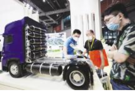
●工作人员(左)向参观者介绍一个重型卡车储氢系统。 方喆 摄
