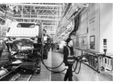
在福田汽车诸城区总装数字化车间里,智能融合一加注设备正为车辆加注工作液。
