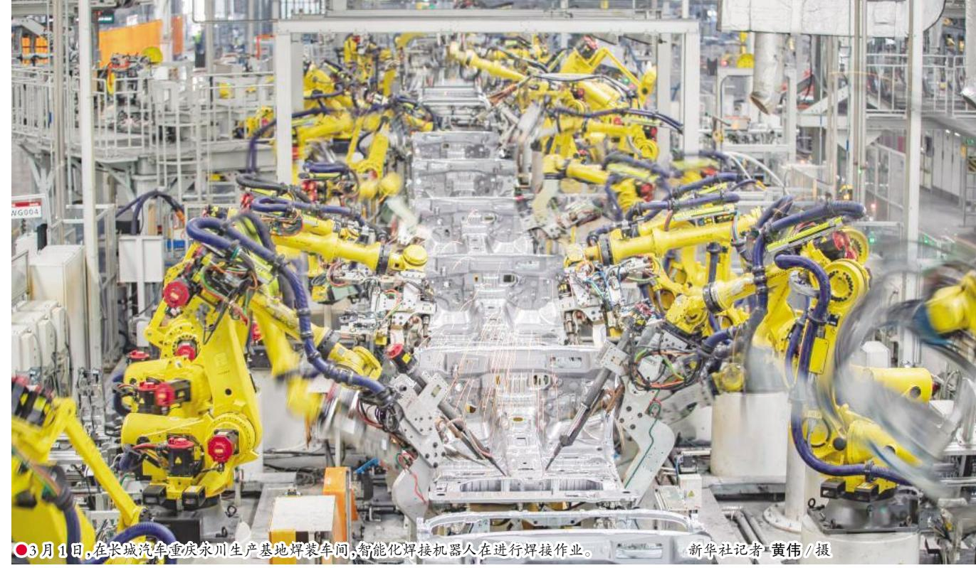
3月1日,在长城汽车重庆永川生产基地焊装车间,智能化焊接机器人正在进行焊接作业。
