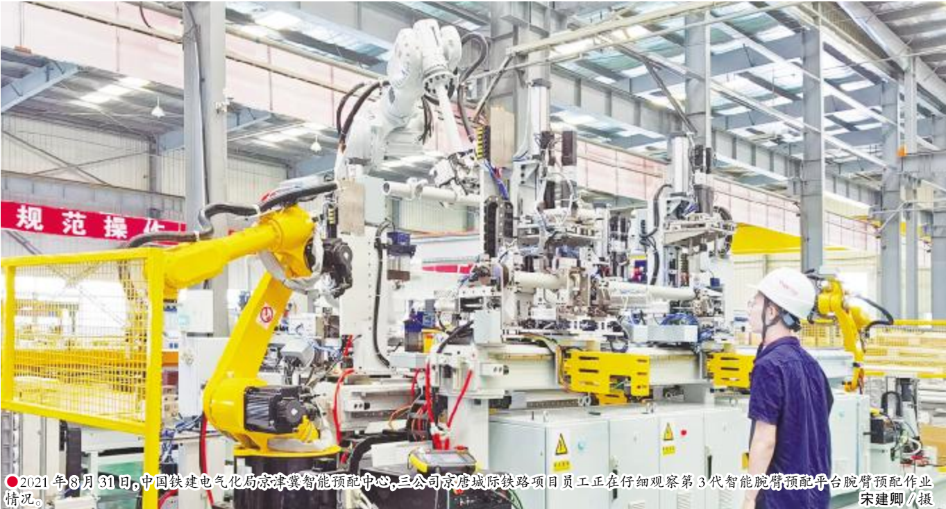
●2021 年 8 月 31 日,中国铁建电气化局天津智能预配中心,三公司京唐城际铁路项目员工正在仔细观察第 3 代智能腕臂预配平台腕臂预配作业情况。
