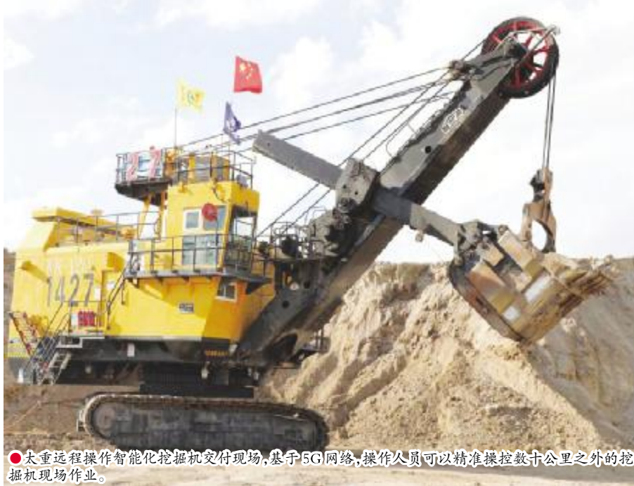
●太重远程操作智能化挖掘机交付现场,基于5G网络,操作人员可以精准操控数十公里之外的挖掘机现场作业。
