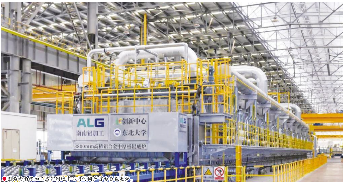
●图为南铝加工热轧制造中心内的国产首套套辊底炉。
