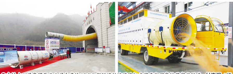
●中铁十八局集团泵业公司生产的 SDDF 型智能隧道轴流风机应用于郑万高铁苏家岩隧道。付宝强/摄
