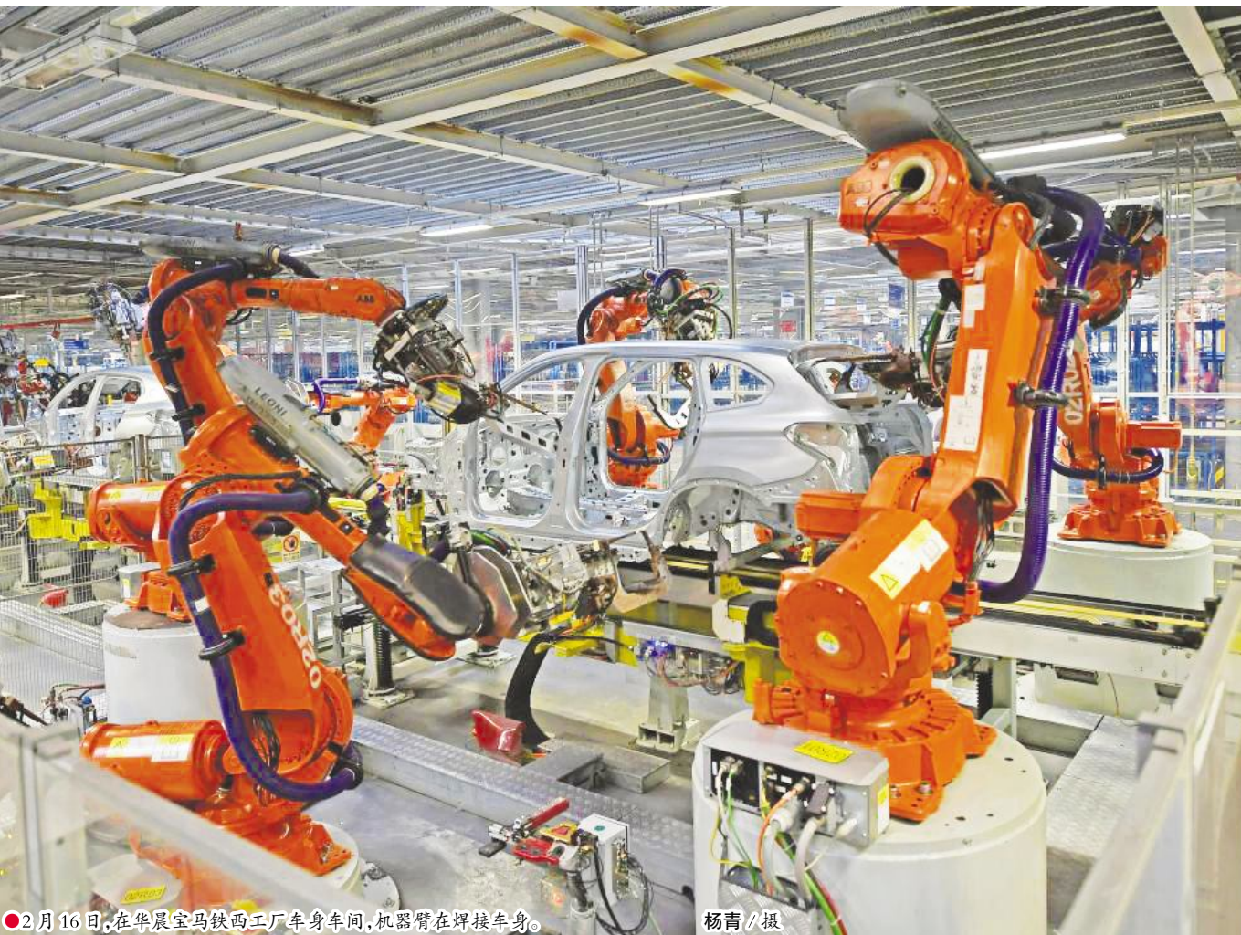
●2月16日,在华晨宝马铁西工厂车身车间,机器臂在焊接车身。
