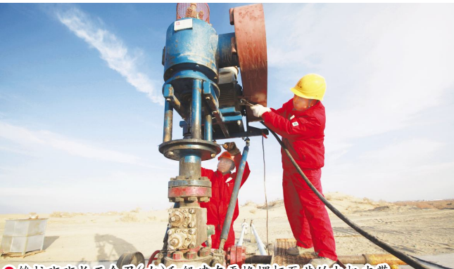
●维护班班长王今召(右)和殷建东更换螺杆泵的电机皮带。
