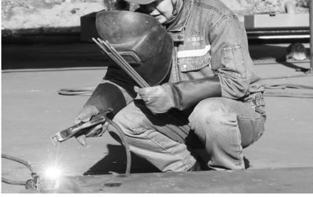
“当时没焊过这么薄的板,焊缝成型不好,黑黑的,焊完之后容易变形,有时还会把线子烧断了。”薄板焊接是国内的技术难题,真正掌握这项技术的,都是行业中的高手,不锈钢薄板焊接的成功经验少之又少。
