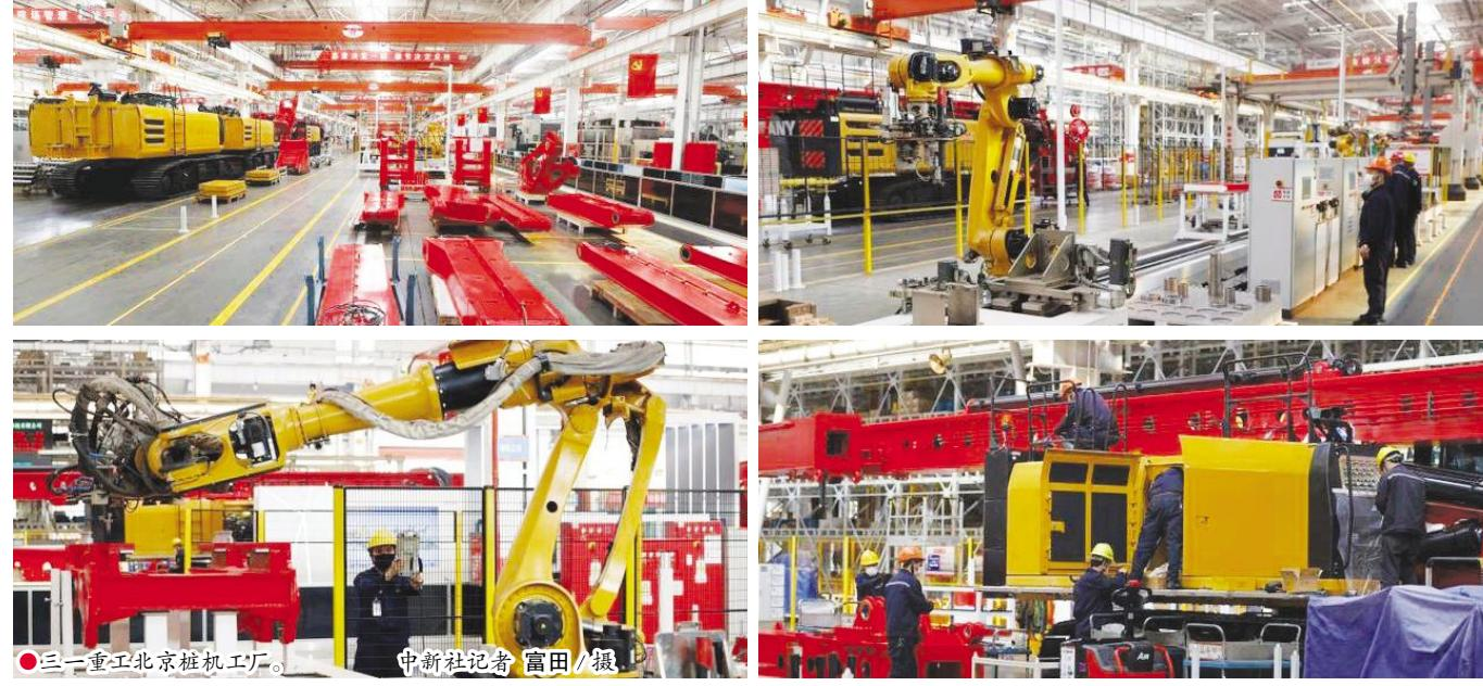
一重工北京桩机工厂共有8个柔性工作中心,16条智能化产线,375台全联网生产设备。总体生产设备作业率从66.3%提升到86.7%,平均故障时间下降58.5%。
