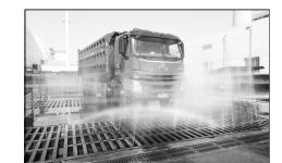
北沙河电厂,一手抓疫情防控,一手抓环保 治理和安全生产。在面对来煤日渐增多的 情况下,近日,该厂投资100多万元的车辆 自动冲洗装置投入使用。该厂车辆自动冲 洗装置是机械自动感应控制,利用 360 度 高压水嘴对车辆的轮胎及底盘部位进行全 方位高压清洗, 从而达到将车轮及底盘洗 净的效果,解决了进出厂区车辆污染降尘 作用。同时车辆的清洗用水可循环使用,
