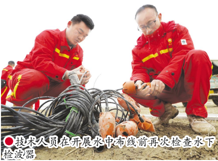
●技术人员在开展水中布线前再次检查水下检波器
