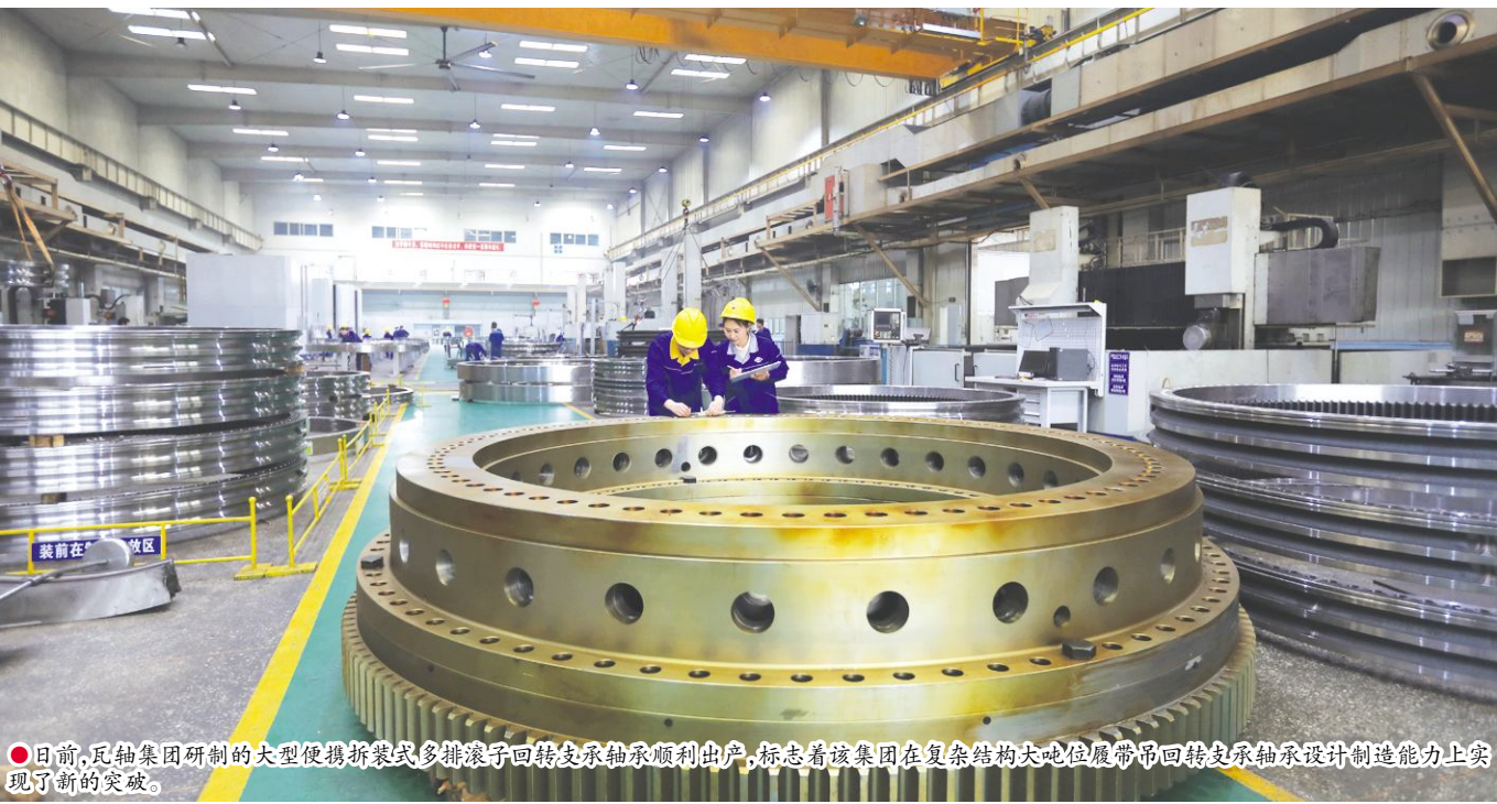
●日前,瓦轴集团研制的大型便携拆装式多排滚子回转支承轴承顺利出厂,标志着该集团在复杂结构大吨位履带吊回转支承轴承设计制造能力上实现了新的突破。
