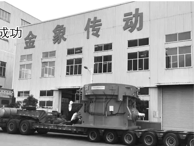
金象传动的大型立式磨机减速机试制成功，正在装车运输。
