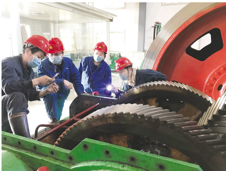
● 该矿机电技术人员正在研究井下提升系统的综合智能化加油装置。
