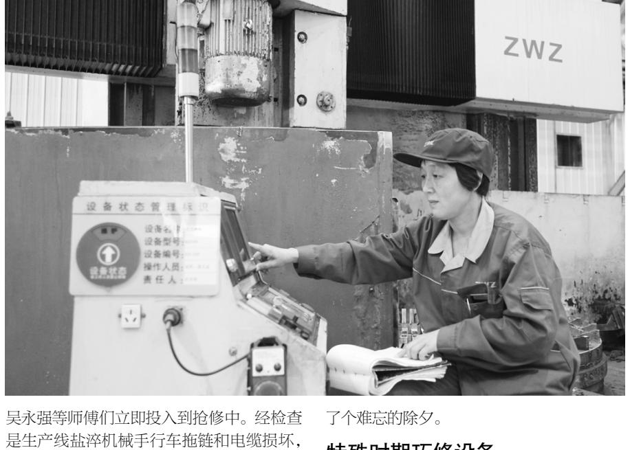
吴永强等师傅们立即投入到抢修中。经检查是生产线盐淬机械手行车拖链和电缆损坏,导致数控系统故障并报警。
