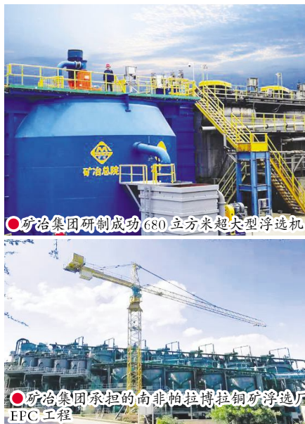
矿冶集团研制的 680 立方米超大型浮选机
