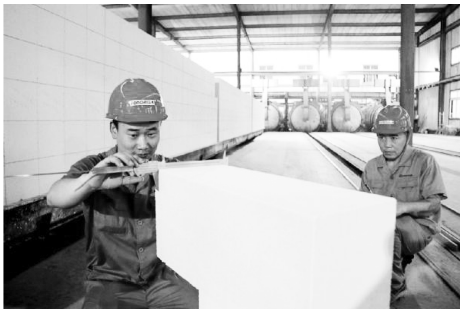
● 质检员对砌块产品进行精密测量
