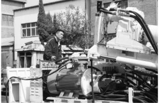
为提高矿井抽采装备水平,安徽淮北矿业集团童亭矿最新引进了一台中煤科工集团西安煤科院研发的ZYD6500LP(A)型煤矿用履带式全液压坑道钻机。该钻机具有功率大、钻孔施工适应性强、便于拆解、便于运输的特点,可通过履带自动行走,在井下使用时大大方便了工人挪钻及安装钻机的工作,性能可靠、移动稳固、快速方便,能够满足瓦斯抽采孔、穿层孔、探放水孔以及其他各类钻孔施工,为矿井瓦斯抽采达标再添保障,也填补了矿井没有大功率、大口径钻机的空白,助推矿井加速迈向质量时代。
