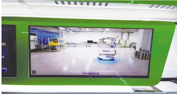
●一台机械臂接受指令后,从左边抓起一个零件安装到右边,然后自动行走走到下一个工位完成后续动作。
