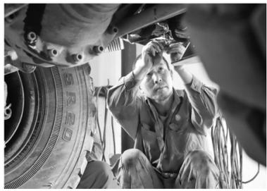
●汽车电工肖生在检查车辆大灯线路
