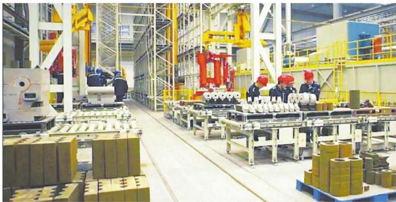
●3D 打印气缸盖组合芯。(四川共享铸造有限公司供图)
