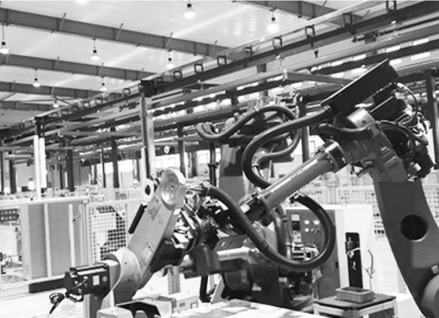
●在中国最大的机器人产业化基地沈阳新松机器人公司的生产车间，干活的都是机器人，它们准确地抓取零部件，组装一台台体型稍小的机器人；一辆辆无人驾驶的物流车行驶在各自通道上，接货后准确地送到下一个工位上。
