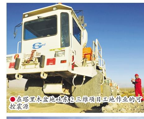
● 在塔里木盆地吐东2三维项目工地作业的可控震源
