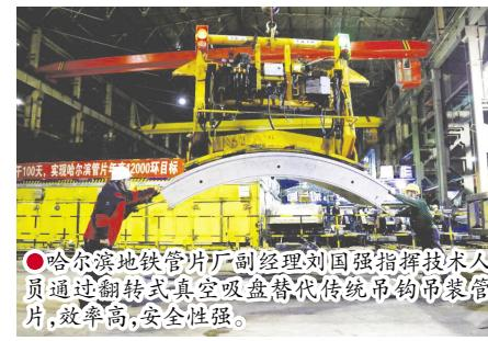
一套成熟的流水线施工技术,实现了管片的优质高产。该厂发明的管片自动翻转机,由起吊到装车一次性完成,减少倒运 2 次,有效地降低了管片磕碰几率,该项成果已获国家专利。
