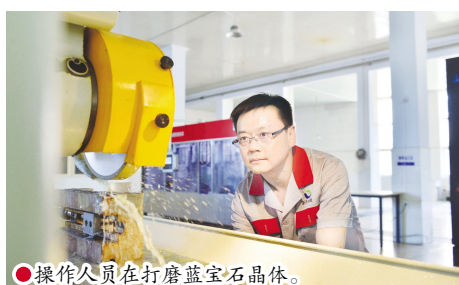
操作人员在打磨蓝宝石晶体。
