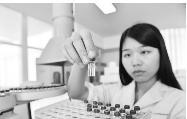
●在福建省泉州市安溪县的国家级茶叶检测重点实验室,检验检疫人员正对茶叶提取物进行农残检测。
