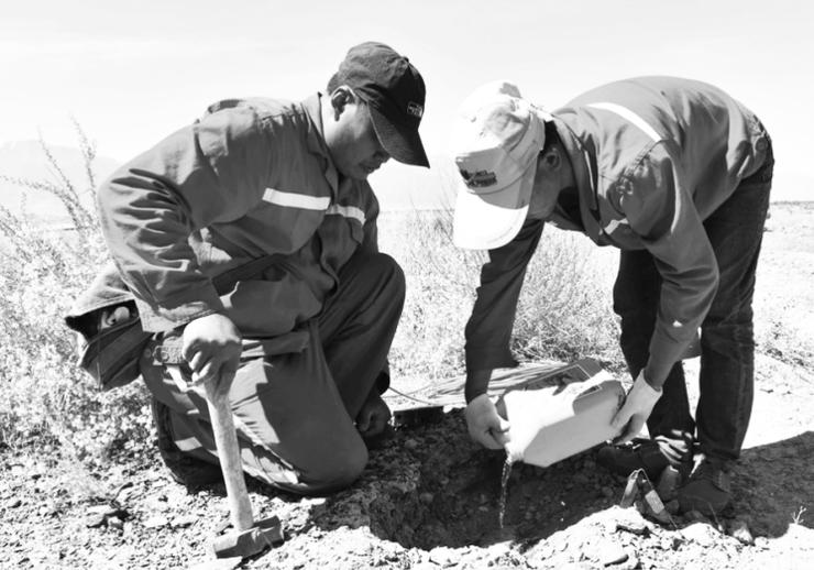
用水浇灌埋置坑,使检波器和大地耦合得更好
