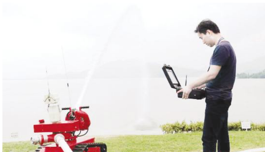
●工作人员正在操作消防灭火机器人。何蒋勇 摄
